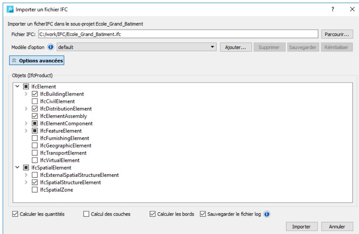
Figure 1- Fenêtre d'import IFC
