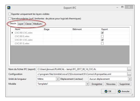
Si souhaitées par l'architecte, les ProvisionforVoids (« propositions de réservations ») peuvent être exportées en option, sous forme d'un fichier IFC séparé de préférence. Celles-ci permettent une vérification visuelle rapide des futures réservations et l'architecte peut également générer ses orifices en se basant sur la géométrie de ces dernières.
